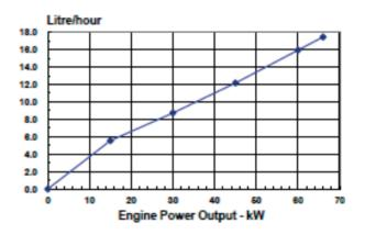
Las cuervas mostradas anteriormente representan las capacidades de rendimiento de los motores en bruto, obtenidos y corregidos en acuerdo con GB/T18297 en condiciones de 100 kPa (29,61 in. Hg), presión barométrica [80 m (263 ft.) altitud], 25 °C (77 °F) entrada de la temperatura del aire y 1 kPa (0,30 in. Hg) presión de vapor de agua con No. O combustible diesel.
